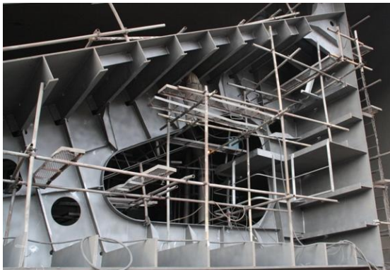
(a) Whole block blasted to Sa 2 ½
