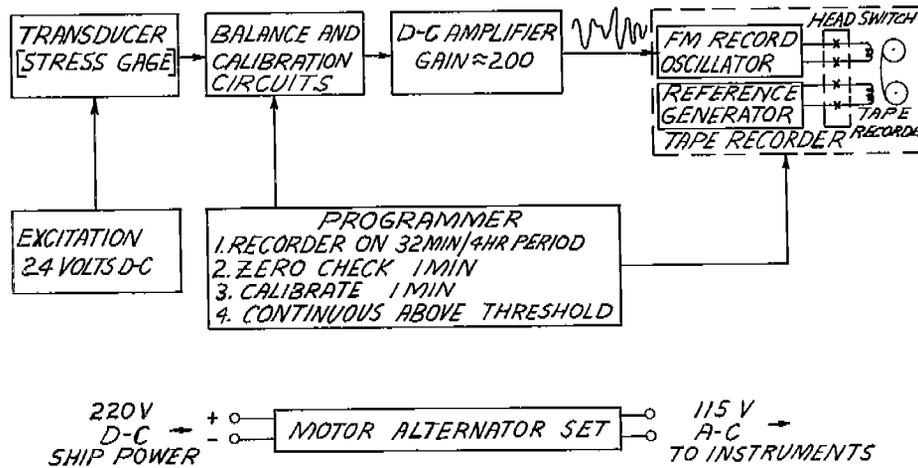
FIG. 5. DATA RECORDING SYSTEM (STRESS CHANNEL)
