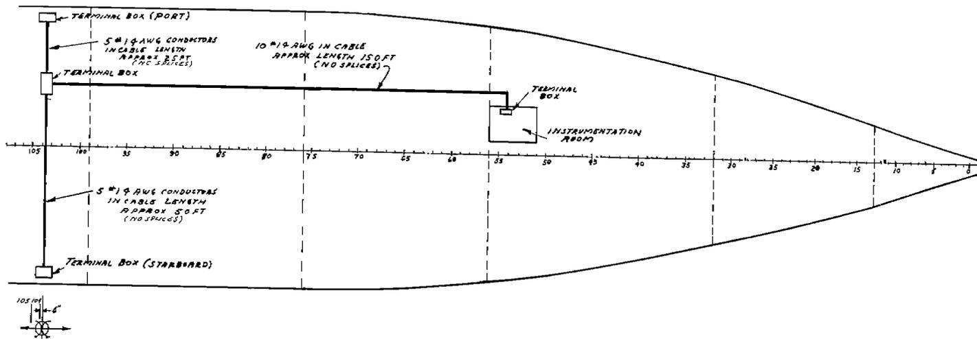
FIG. 8. WIRING LAYOUT STRAIN GAGE CIRCUITS.
