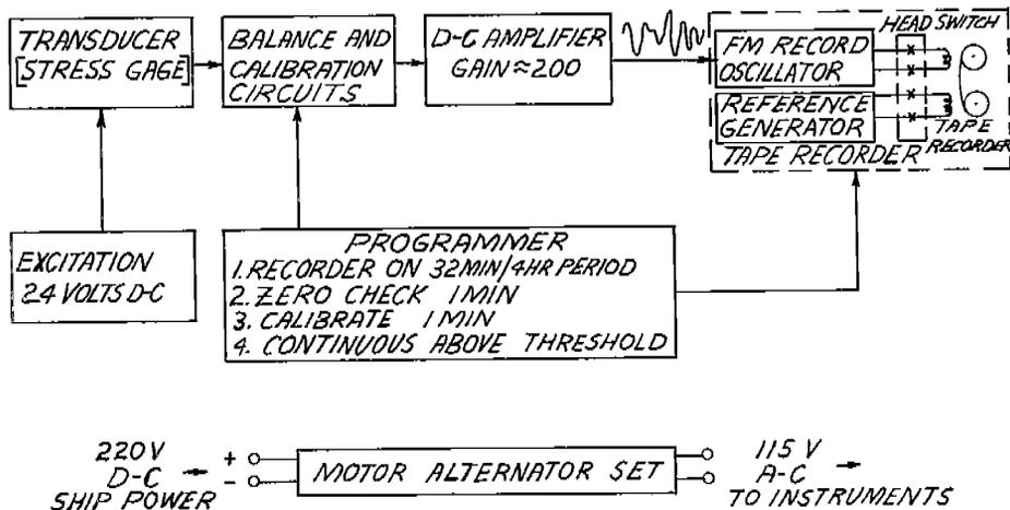
FIG. 5. DATA RECORDING SYSTEM (STRESS CHANNEL)
