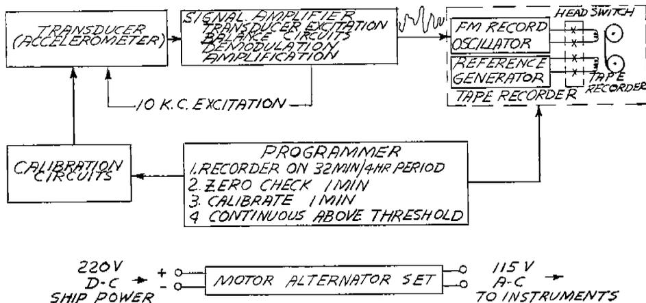
FIG. 6. DATA RECORDING SYSTEM (ACCELERATION CHANNEL)
