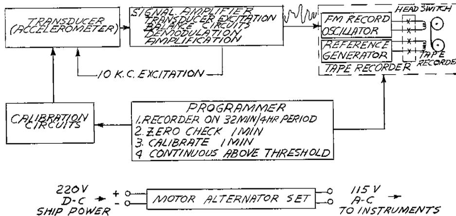
FIG. 6. DATA RECORDING SYSTEM (ACCELERATION CHANNEL)
