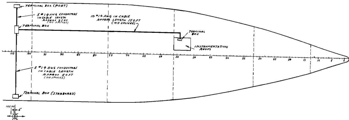
FIG. 8. WIRING LAYOUT STRAIN GAGE CIRCUITS.
