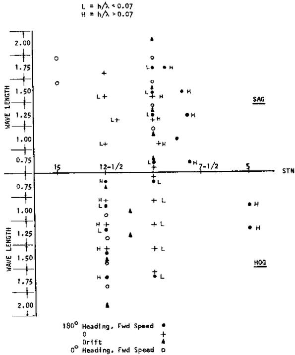
FIG. 55. LOCATION OF BENDING MOMENT MAXIMA, MODEL 2681-1.
