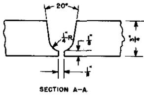
FIGURE 58. SPECIMEN FOR RESTRAINT-TYPE TEST
