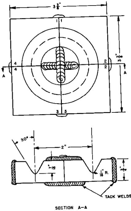
FIGURE 56. CIRCULAR GROOVE SPECIMEN FOR RESTRAINT-TYPE TEST.
