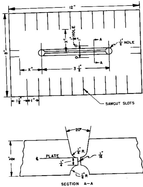
FIGURE 57. FIN SPECIMEN USED FOR RESTRAINT-TYPE TESTS.
