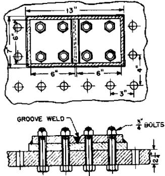
FIGURE 54. RESTRAINED SPECIMEN FOR CRACKING TEST.
