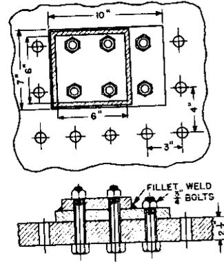
FIGURE 55. RESTRAINED FILLET-WELDED SPECIMEN FOR CRACKING TEST. (REEVE TEST).
