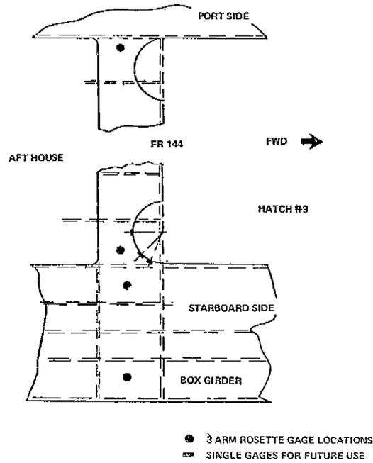
FIGURE A-10 -- AFT HOUSE/HATCH ROSETTE GAGE LOCATIONS
