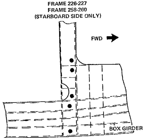
FIGURE A-11 - HATCH TRANSITION ROSETTE GAGE LOCATIONS
