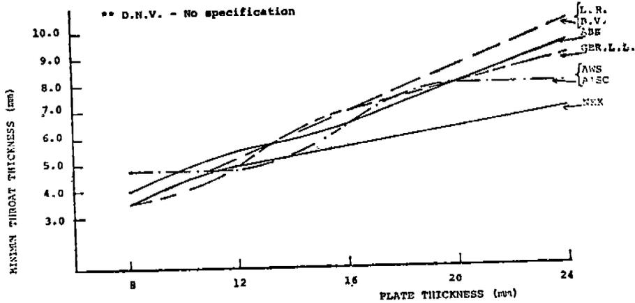
FIGURE 3.2j CURRENT WELDING REQUIREMENTS FOR JOINTS BETWEEN RUDDER JOINTS ON THE MAINSTOCK
