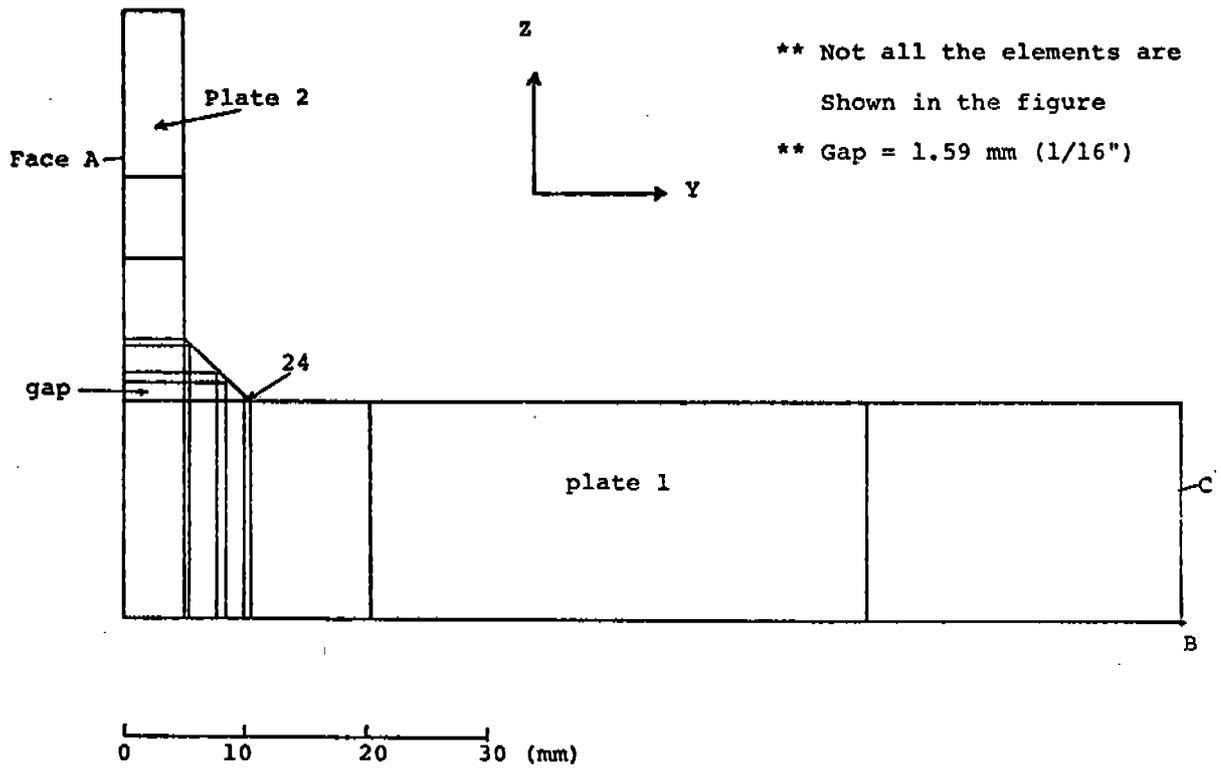
FIGURE 4.4 FINITE ELEMENT MESH FOR TEST RUN
