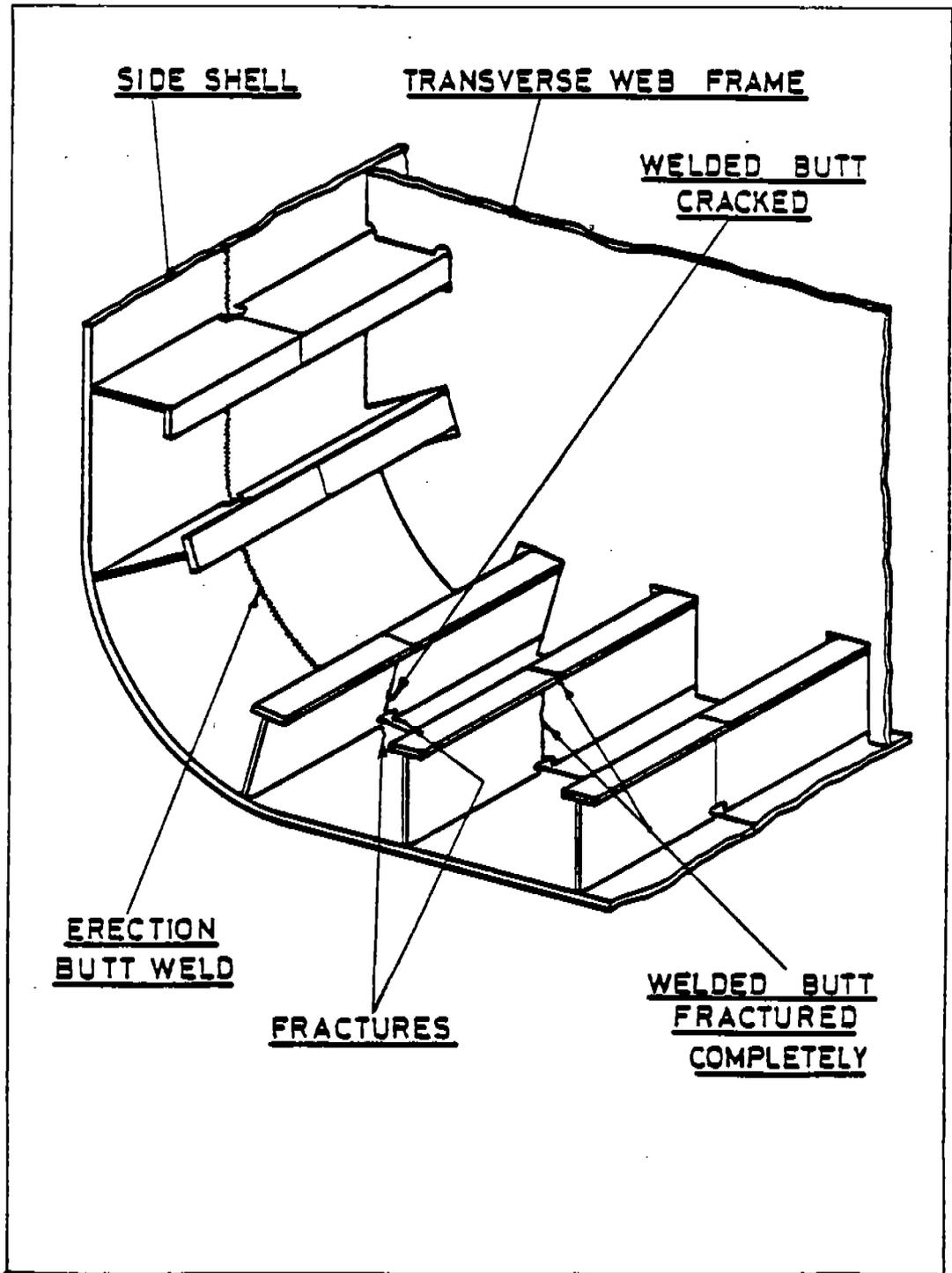
Figure 24: TYPICAL BOTTOM LONGITUDINAL CRACKING
