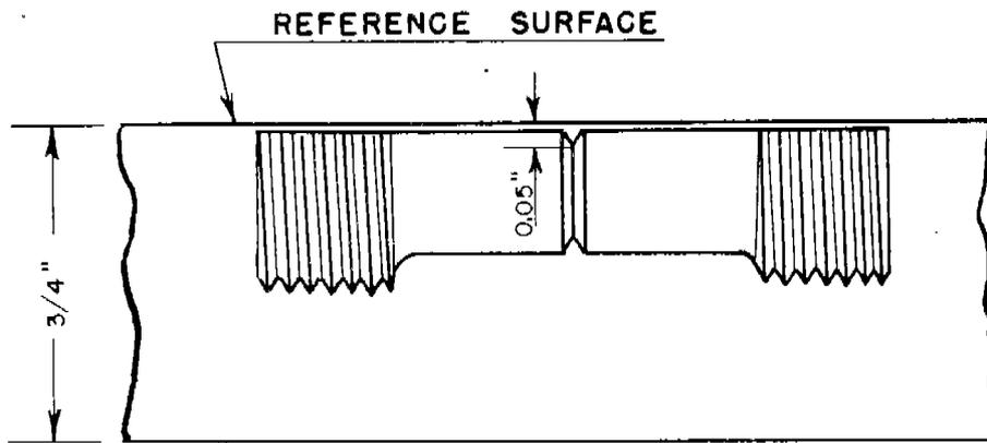
FIG. 4: LOCATION OF ECCENTRIC NOTCH SPECIMEN AT THE SURFACE LEVEL
